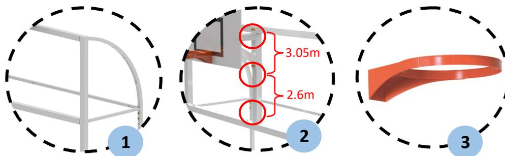
1. Les barres de renfort arrière 50x50mm viennent renforcer le haut de la structure
