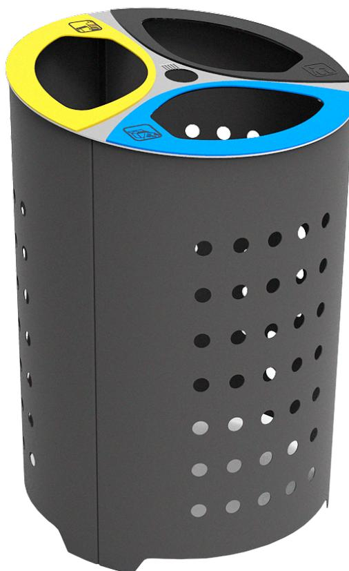
La corbeille Doria est destinée à la séparation de déchets recyclables. Inclut un cendrier. Structure en tôle d'acier de 2mm, perforée avec anneau de renforcement. Traitement par cataphorèse du corps de la poubelle et thermolaquage coloris oxiron noir. Couvreclé supérieur en acier inoxydable AISI 304 avec 3 trous pour éviter que les gens y jettent des sacs poubelle domestiques.
