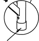
LAISSER le capuchon de protection, le RETIRER lors du montage du pied (pour éviter toute détérioration du coin)
