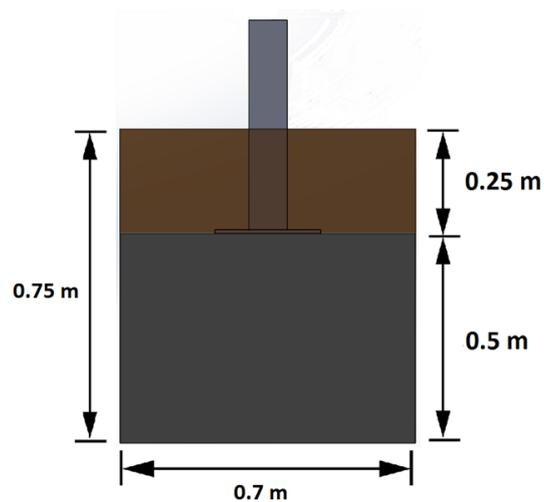
Creuser 1 trou destiné au béton suivant le plan ci-dessus.
