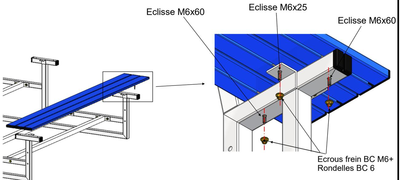
Il y a deux plats sur les côtés, pour qu'ils puissent être utilisés à gauche ou à droite. Il n'y a besoin que de fixer un des plats.
