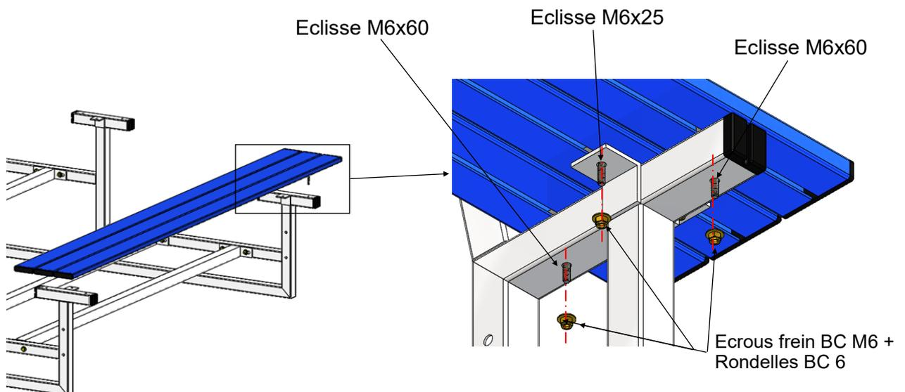
Il y a deux plats sur les côtés, pour qu'ils puissent être utilisés à gauche ou à droite. Il n'y a besoin que de fixer un des plats.
