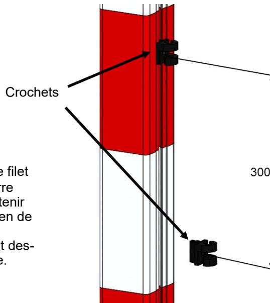
Positionner les crochets de fixation de filet sur la filière des montants et de la barre transversale en prenant soin de maintenir entre chaque crochet un espace moyen de 300 mm.
