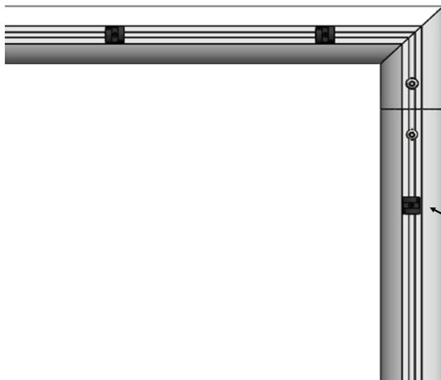
Clipser les crochets dans la glissière du tube aluminium (montants et transversale) à l'aide d'un maillet, en maintenant un espace entre chaque élément variant de 300 à 350mm afin d'en assurer une équidistance entre chaque.
